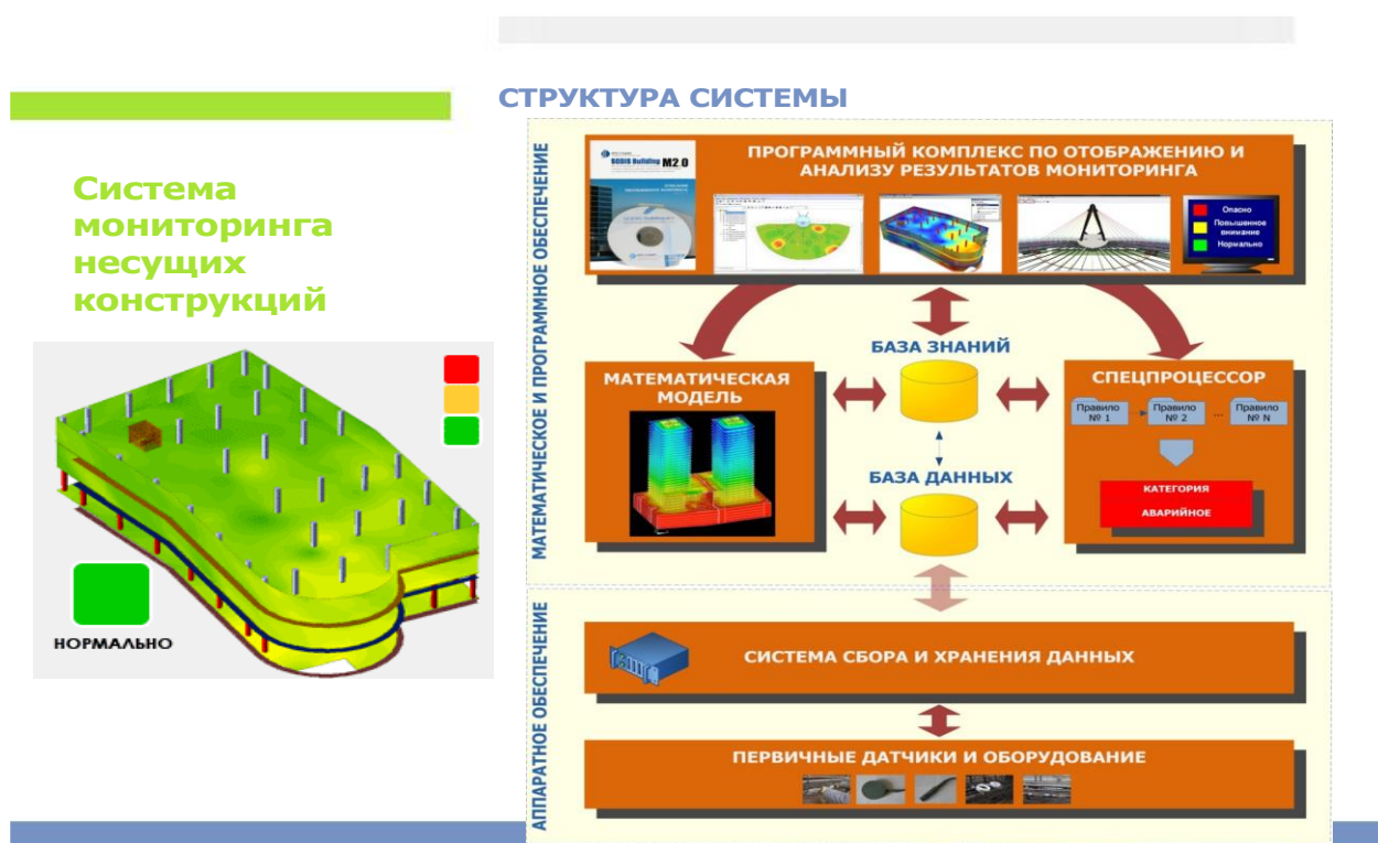
Рис. 3. Блок-схема системы мониторинга строительных конструкций здания
