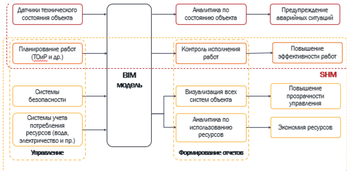
Рис. 2. Составляющие автоматизированной системы эксплуатации зданий
