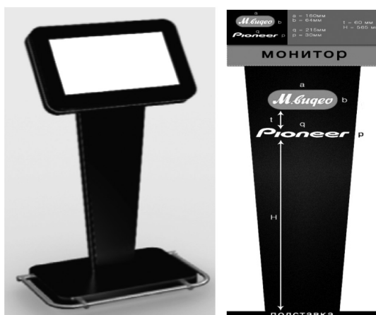
Рис. 1. 3D-модель и эскиз интерактивного терминала
