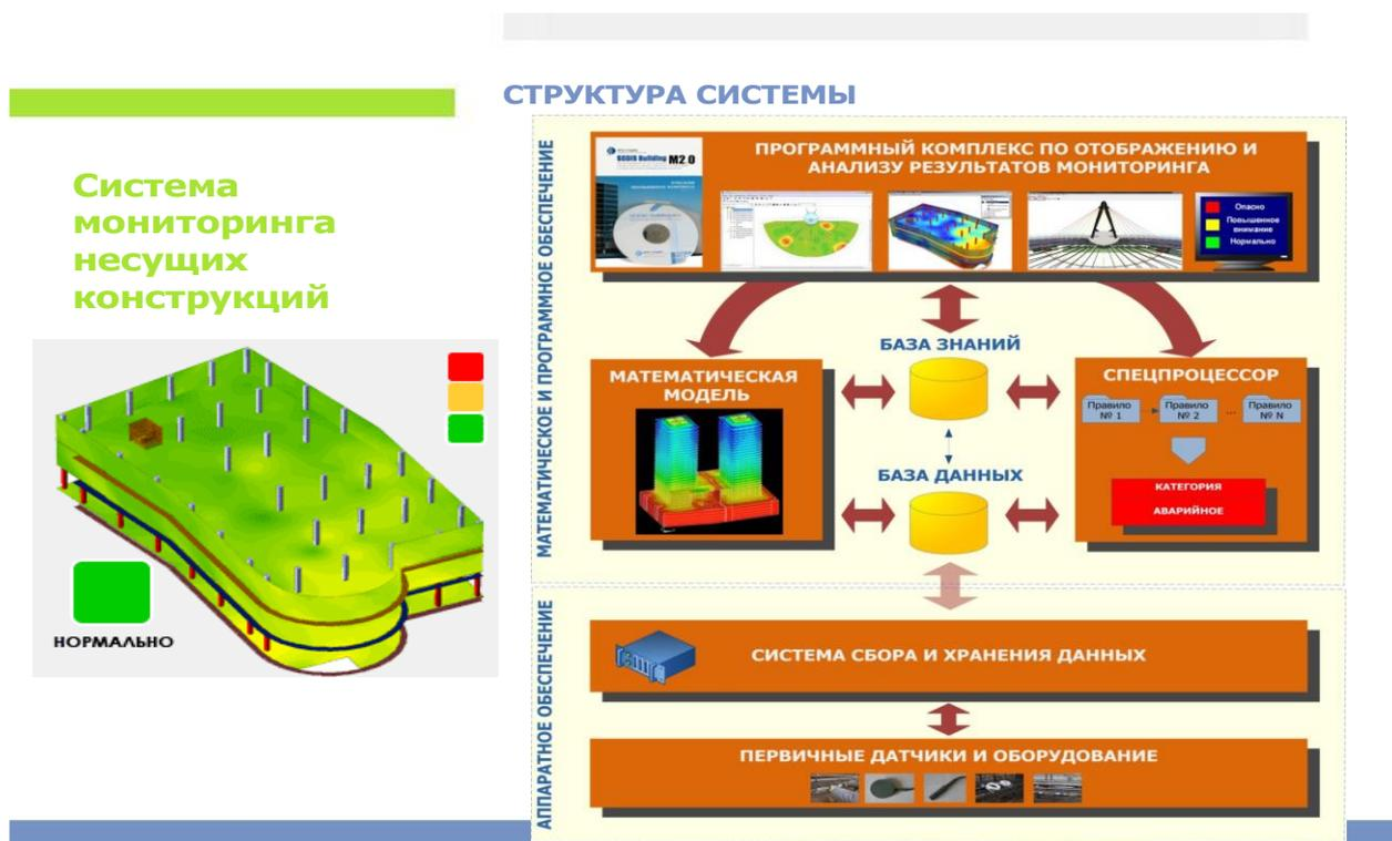
Рис. 3. Блок-схема системы мониторинга строительных конструкций здания
